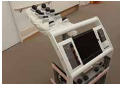
(一眼レフカメラ10台備えた装置で乳房のデータを取得)
